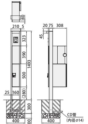
軟弱地盤でのコンクリート基礎埋め込み深さ、周囲巾は十分に取ってください。PF管(φ16)をお使いの場合は付属のコネクタをご使用ください。
