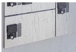
雨水が浸入しづらく、万が一浸入しても荷物が濡れにくい防滴構造です。扉の上面に溜まった雨水は本体の溝に流れ込み、本体左右の補強金具の内側を流れて排水されます。
