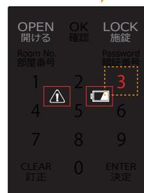
バッテリー残量が約2週間となっています。荷物を取り出す以外の操作ができなくなります。直ちに電池交換をしてください。
