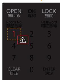
電子錠の異常を検知しました。電池の交換を行ってから電子錠の裏側にあるリセットボタンを押してください。施錠状態の際は上記「電子錠が全く反応しない場合」をご覧ください非常給電を行ってください。CLEAR(訂正)を押してから開錠して、電池交換及び、リセットを行ってください。
