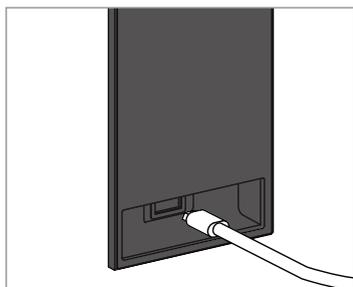
タッチパネルを触っても反応がない場合は電池が完全に切れている可能性があります。正面にある給電口カバーを取り外して、ポータブル電源(USBケーブル:Type-B)で、給電口にあるUSBへ給電してください。動作可能になりましたら、速やかに電池交換を行ってください。(P.2参照)
