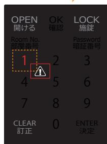
電子錠の異常を検知しました。電池の交換を行ってから電子錠の裏側にあるリセットボタンを押してください。施錠状態の時は上記「電子錠が全く反応しない場合」をご覧いただき非常給電を行ってください。CLEAR(訂正)を押してから開錠して、電池交換及び、リセットを行ってください。
