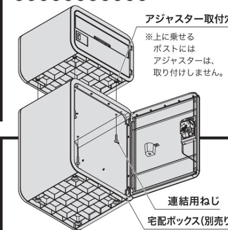
3 下の宅配ボックスの内側から、付属の連結用ねじで、上のポストと固定する。
