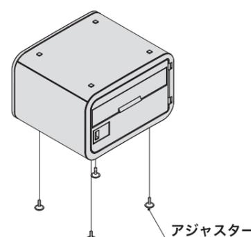
2 本体内側より、プラスドライバーでアジャスターを調整し、製品の水平を出す。
